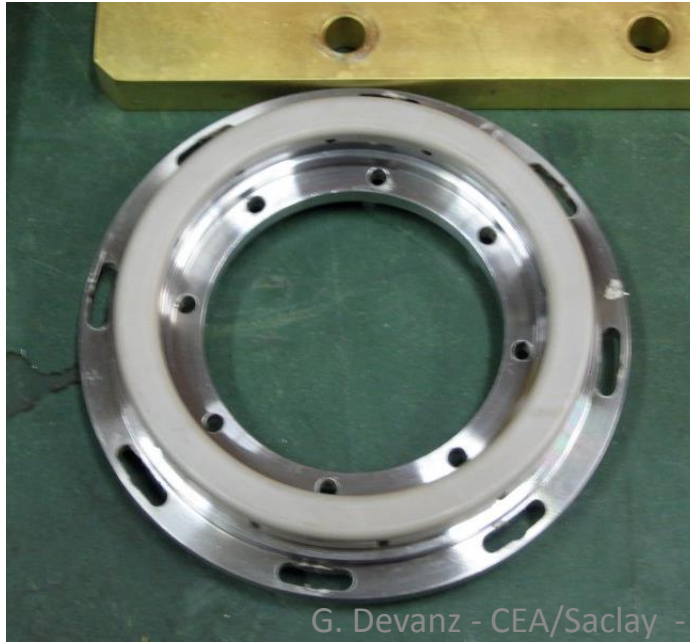
DESY TTF-3 HV capacitor
