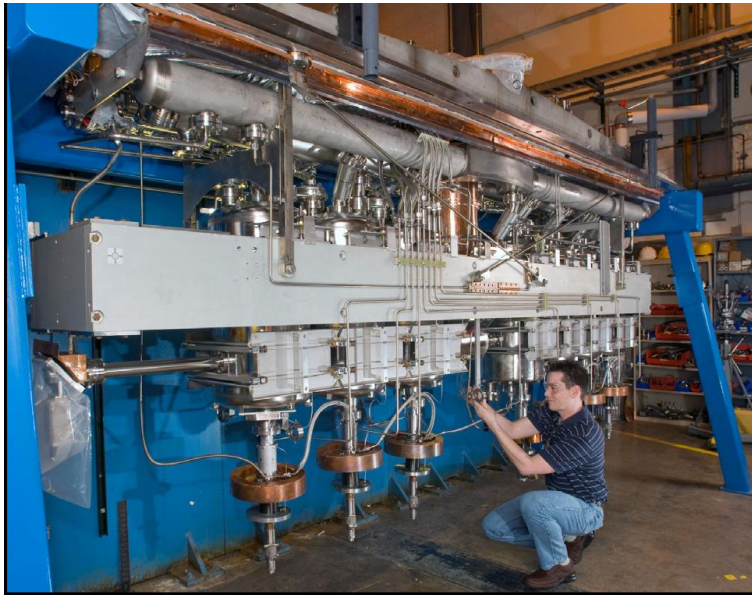
Top-down cryomodule (ANL)
