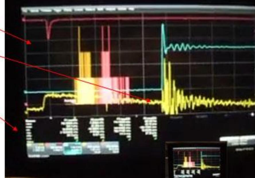
Triple x coïncidence  $E \wedge \Delta E \wedge \text{SiPix}$
