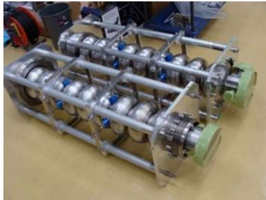
ERL model-2 9cell cavities for cERL
