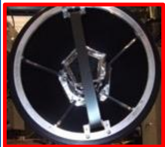
SCEPTAR: 10+10 plastic scintillators
